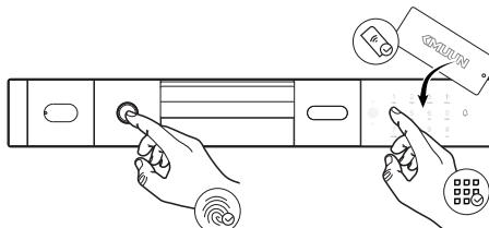
**指纹配置：**用户将需配置的手指放到「外机」的指纹采集器上，语音播报「请再按手指」重复录入操作若干次，直至语音播报「操作成功」后，此指纹录入成功，按压失误与中断会导致录入失败。
