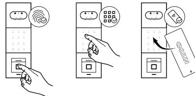
**指纹配置：**用户将需配置的手指放到「外机」的指纹采集器上，语音播报「请再按手指」重复录入操作若干次，直至语音播报「操作成功」后，此指纹录入成功，按压失误与中断会导致录入失败。
